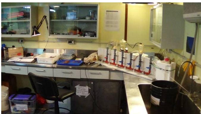
Figura 13.2. Espacio de laboratorio a bordo. Se observa el sistema de manifold utilizado para filtración de las muestras de agua, fitoplancton y zooplancton.
