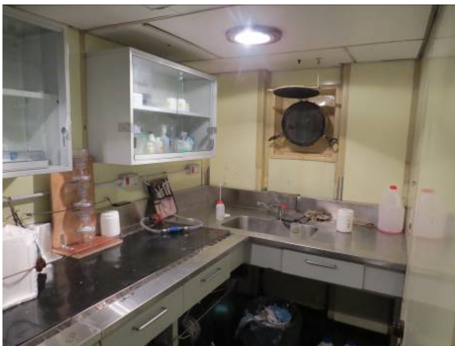
Figura 1: Gabinete de microbiología del Buque oceanográfico ARA Puerto Deseado. Puede observarse la columna de para la filtración de clorofila fraccionada (Foto: Natalia Paso Viola).
