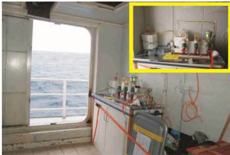
Figura 2. Espacio de laboratorio a bordo del Tango. En recuadro superior detalle del sistema de filtrado.
