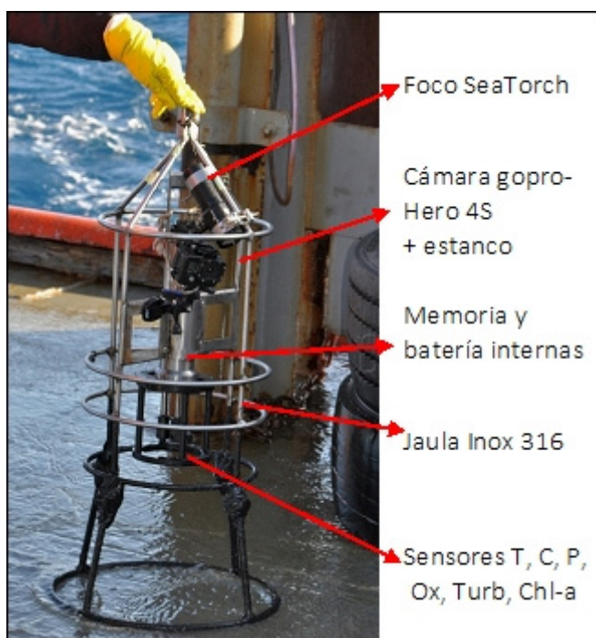
Figura II.1. CTD Rinko ASTD-102 y equipo de filmación integrado.
