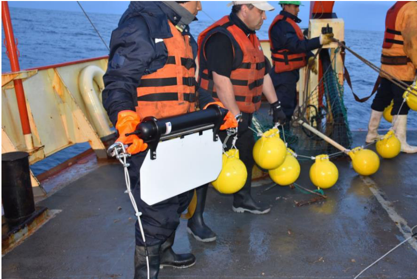
Fig. 9.4.1. Correntómetro Aquadopp a punto de ser fondeado. Foto: Alex Martínez
