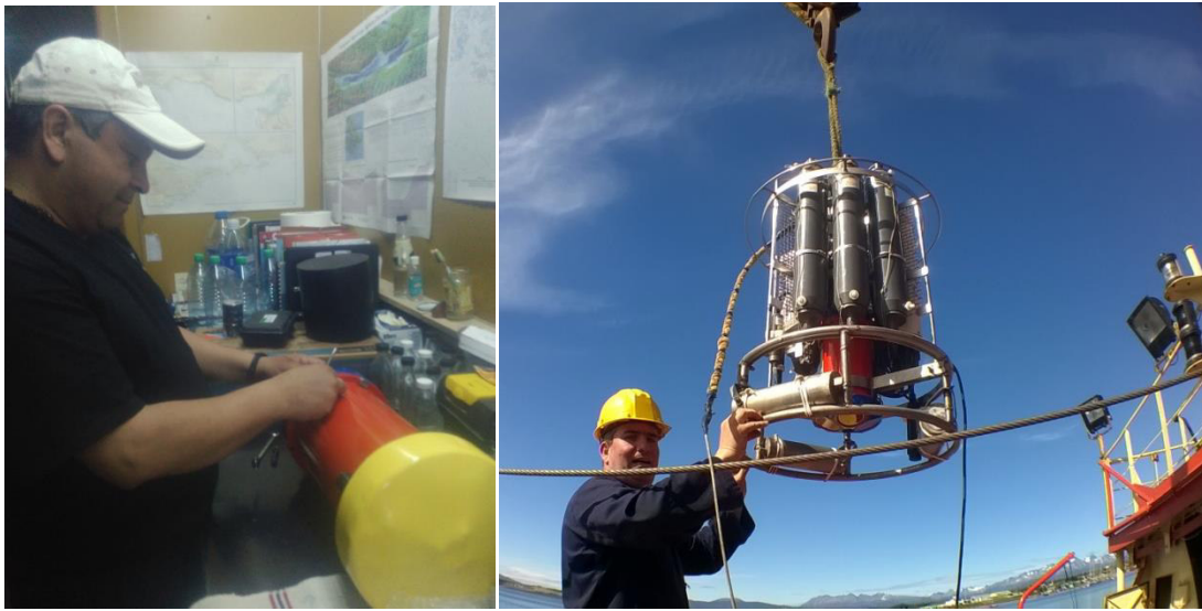
Figura 9.3.1 [izquierda] Instalación del pack de baterías en el ADCP, [derecha] calibración del LADCP en la popa del buque antes de zarpar. (Foto: Martin Veccia)
