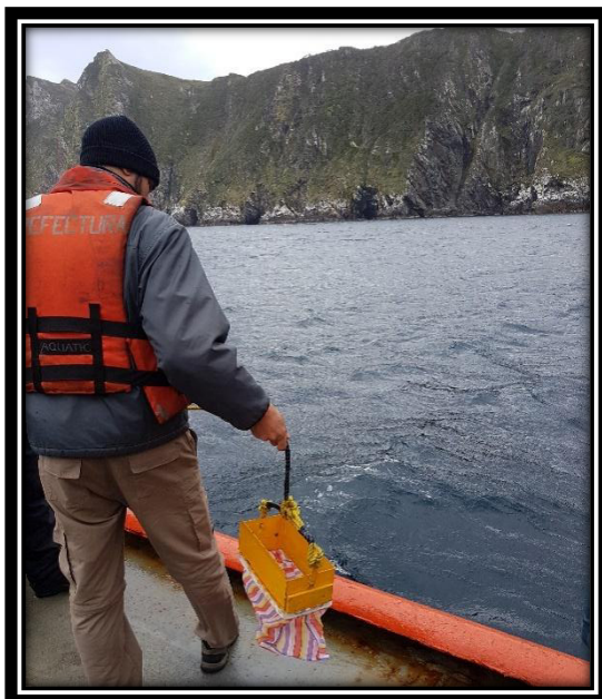
Figura 3. Lanzamiento de rastra de mano.
