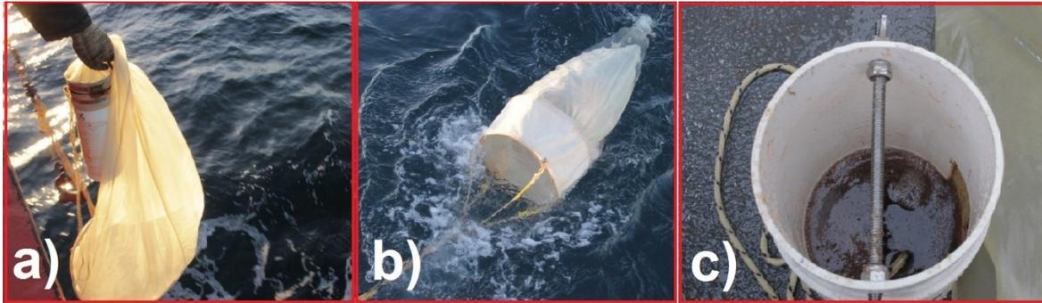
**Figura 1.** Detalle de las maniobras realizadas con red cónica de 0,6 m de diámetro, 2 m de largo y mallero de 200  $\mu\text{m}$ . a) alzado de la red, b) red en el agua, c) muestra colectada que luego se trasvasa a un frasco plástico para su posterior almacenamiento en frascos rotulados.
