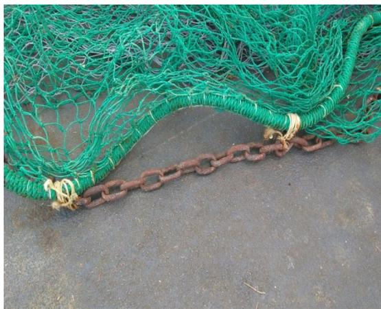
Figura 7. Detalle del montaje de la cadena de lastre a la relinga inferior de la red piloto
