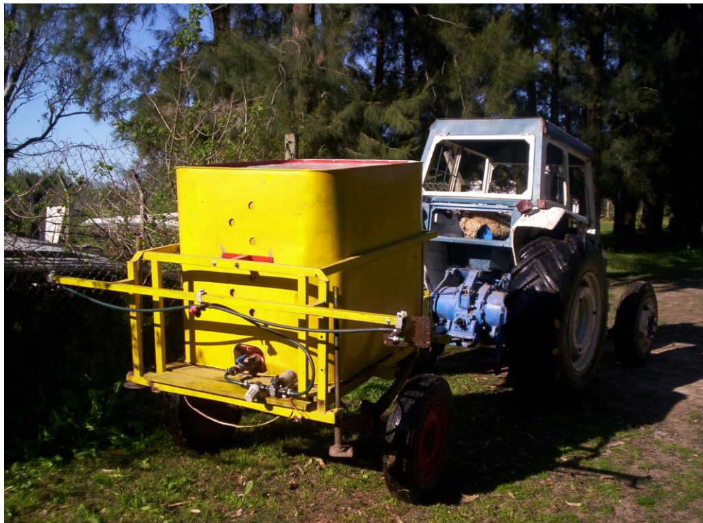
Figura 10: Equipo pulverizador traccionado por tractor para aplicaciones sobre carda ( Dipsacus fullonum ) en cobertura total, con botalón de tres picos accionados por una bomba eléctrica. Diseñado por Ing. Agr. Carlos Sarubbi. Reserva Natural Otamendi (actual Parque Nacional Ciervo de los Pantanos), 2005.
