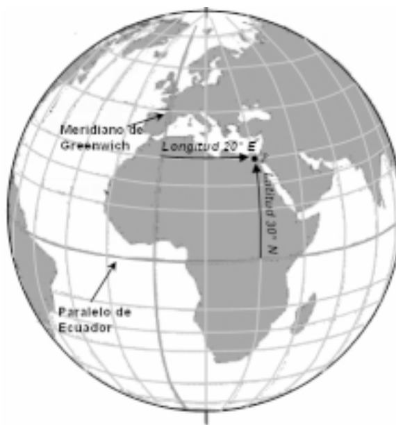
Figura 3.4.2 Medición de la latitud y la longitud
