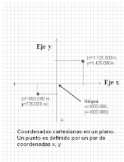
Figura 3.4.5 Sistema de coordenadas planas o cartesianas
