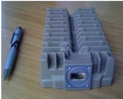
Amplificador para transmitir señales hacia el satélite (ODU).
