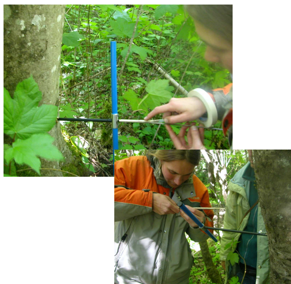
Foto 24: Con el barreno se extrae un tarugo de madera del interior del tronco y es posible detectar la pudrición y la distancia de la madera sólida (Chauchard).
