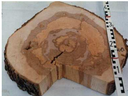
Fotos 6 y 7: Phellinus andinopatagonicus , detalles de la pudrición blanca fibrosa en duramen, en corte longitudinal (Izq. Jovanovski) y transversal de un fuste de lenga (Der. Cwielong).
