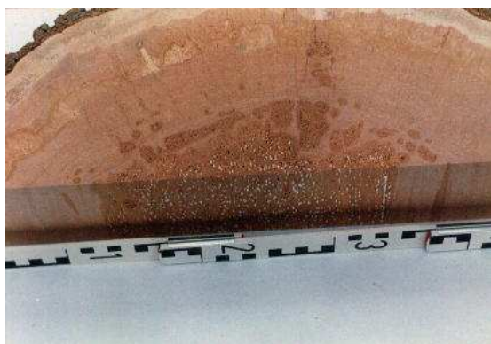
Fotos 9 y 10: Aurantioporus albidus , detalles de la pudrición blanca alveolar en duramen, en corte transversal y longitudinal de un fuste de lenga. (Cwielong)
