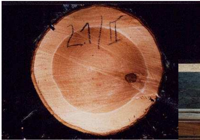
Foto 20 y 21: Fistulina antarctica , detalle de la castaña dura en duramen típica de esta especie transversal y en tablas de lenga. (Cordone)
